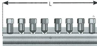
Der Systemschnitt zeigt die patentierte Stabfixierung im Inneren und die patentierten Schrauben an den Außenkanten der LENTON LOCK Muffe
