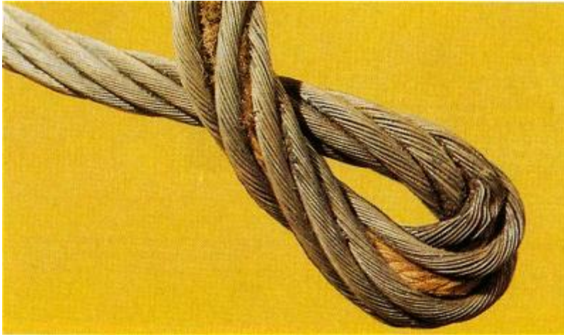
Bild 23-4: Kinke/Klanke und Eindrückung einer Litze. Der Seilverbund ist zerstört: Ablegen!
